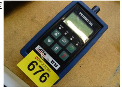
**677**      **1 x Anlerngerät für Reifendrucksensoren**      1,00 €
