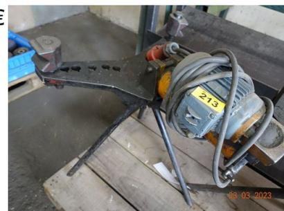
**214 1 x Hydraulisches Rohrbiegegerät RASI**
