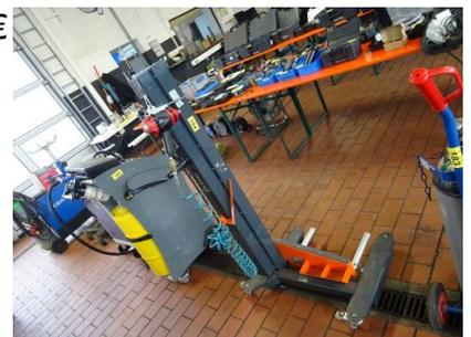
**185 1 Bremsflüssigkeits-Füll- und Entlüftungsgesät VAS6860**
