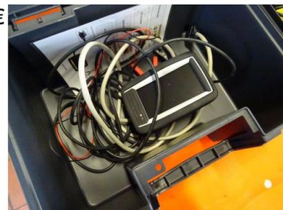
**190**      **1 Airbag-Prüfadapter VAS5056 C**
