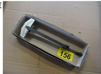
**157 1 Drehwinkelmesser für Ratschenschlüssel
